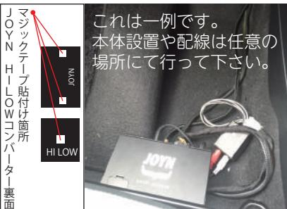
6 付属延長LANケーブルと両面テープを使用してJOYNコントローラーを任意の場所に設置します。
