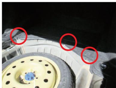
**4** クリップ外しなどの専用工具を使用すると作業性が良いです。
