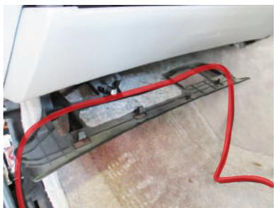
**23** エアコンパネル横のサイドパネルを左右とも取り外します。サイドパネルの奥と下の辺りを持って、手前に引き抜く様に外します。反動にご注意下さい。(ツメのみ)
