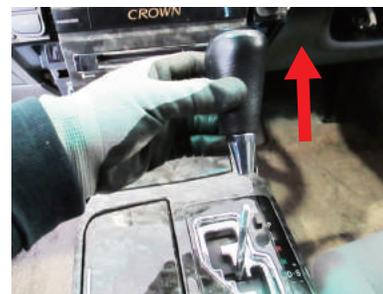
**25** センターコンソールの手前側を上を持ち上げます。赤○2箇所のカプラーを取り外します。(センターパネルはツメのみ)
