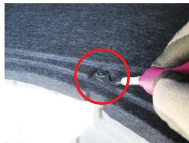
**5** トランクルーム内上部の内張りを留めるクリップとキャップも取り外します。※全3箇所ありますが、**5**では赤○2箇所。次の**6**で残り1箇所の位置をご説明します。
