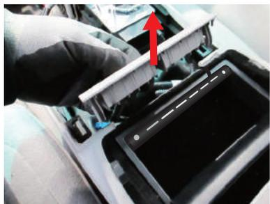
**28** トランクルーム内に向かって右側のカバー下に純正アンプが設置されています。赤○箇所のクリップを取り外し、カバーを外します。
