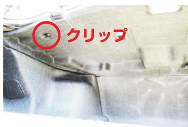
**7** トランクルーム内上部のクリップ形状(2箇所)は、横面(赤○)に設定されているボタンを押さえながら引き抜く様に外します。
