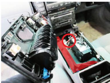
**27** 本手順書はJOYN SMART STATION付属コントローラー設置をコンソールBOX内とする為、全面部のパネルを上方向へ取り外します。
