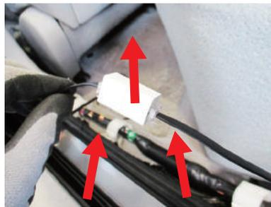
**19** 赤○3箇所にある結束用の白い樹脂パネルのツメを外して、その中にLANケーブルを配線します。
