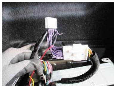
**34** 純正20PINカプラーと、サウンドアップハーネス24PINカプラーのオス(メス端子)を純正アンプに接続します。
