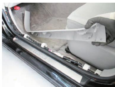
**12** グローブBOX下のアンダーパネルも取り外します。赤○3箇所に、指で押さえて外すツメがあります。※配線できる程度に外します。
