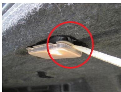
**9** 赤○右のツメを押しながら片側を外す事で、赤○左のフックで引っ掛けて留めている箇所を外せます。カプラーも取り外します。
