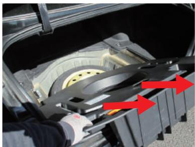
**3** 赤○3箇所のフロアマットを留めるクリップを取り外します。
