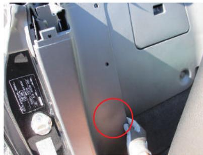
**15** バックパネル全体を持って手前に引き抜くように取り外します。赤○箇所にバックパネルと車両とを繋ぐ金具で留まっています。
