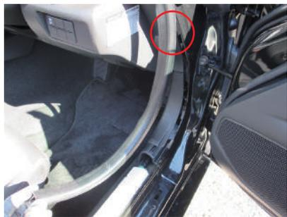
**3** 運転席側キックカバーパネルを取り外します。赤○位置の内張りクリップ(リベットタイプ)を外します。
