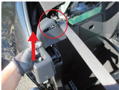
**13** 運転席裏側のバックパネルを取り外す為、赤○箇所2つの内張りクリップ(スクリュータイプ)を取り外します。
