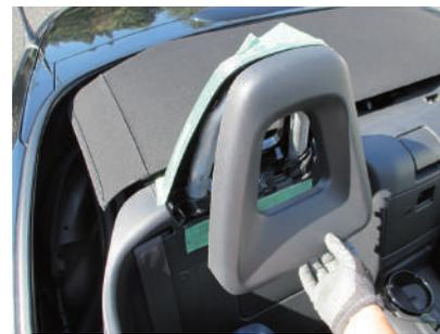
**11** 運転席側シートベルトアンカー周りのパネルを取り外します。赤○箇所の内張りクリップ(スクリュータイプ)を取り外します。
