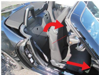
**8** 運転席と助手席バーベゼルの間にあるウィンド・ディフレクターを上方向へ引き抜いて外します。赤○位置のツメで留まっています。
