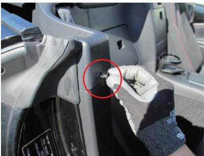
**12** パネルの手前面を上方向に持ち上げながら外しつつシートベルトをパネルの隙間(赤○箇所)から抜き取り、完全に取り外します。
