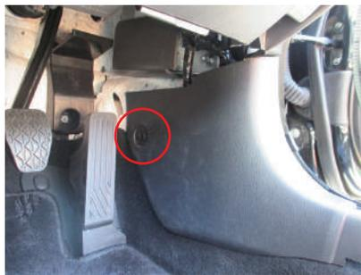
**4** 赤○箇所のドアトリムクリップ付近を持ち、キックカバーパネル全体を手前に引き抜くように、取り外します。
