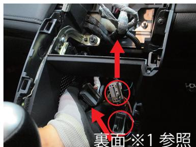
**17** 12で取り外しておいたHI LOWコンバーター接続コネクタをもとに戻します。
