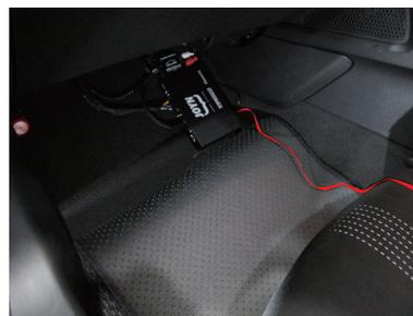
**20** この取付け手順書では、コントローラーをセンターコンソール外側に設置しています。※必ずしも場所は決まっておりません。任意の場所に設置して下さい。
