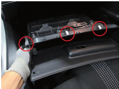
**12** サウンドアップキットのHI LOWコンバーター接続コネクターを取り外し、配線をし易い様にしていきます。
