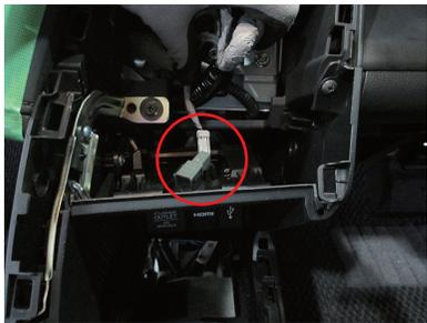
**7** センターコンソール小物置きに設定されているAUX・HDMIなどのインターフェース類を手前に引き抜き、コネクターを外します。
