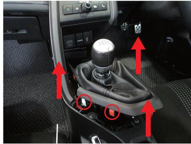
**4** センターコンソールパネルを取り外します。枠のツメ(赤○)で留まっていますので、手前に引き抜く様にして外します。
