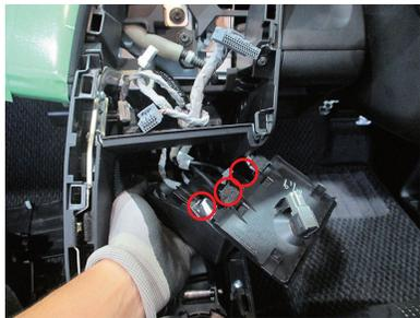
**8** 赤塗り箇所が純正オーディオユニット、赤○内、点線枠が純正電源ハーネス24Pコネクター接続位置。このコネクターを抜いて下さい。
