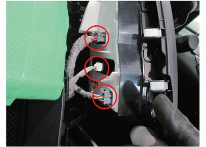
**6** センターコンソールの小物置きを照らすLEDランプのコネクターを取り外します。
