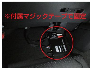
**19** 本体付属のコントローラーを設置するため、サウンドアップキットに同梱している延長LANケーブル(2m)を任意の場所まで配線します。(赤塗がLANケーブル)
