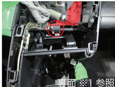
**9** 配線の取出しを行うため、グローブBOXを取り外します。赤塗り2箇所のネジ隠しの黒いパネルを取り外します。
