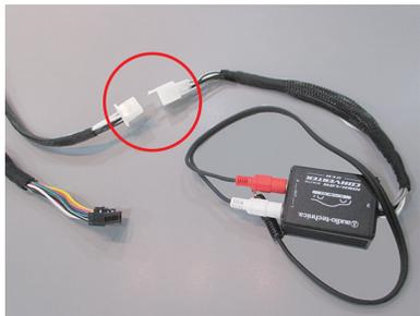
**13** 赤○の間隙に下から上に通して、ホンダ純正の24P電源ハーネスと接続可能になるところまで、サウンドアップキットを配線します。
