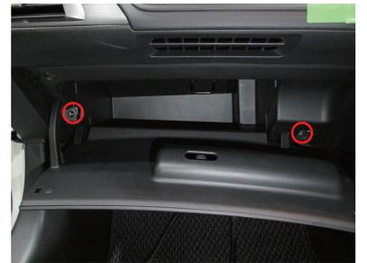
**11** グローブBOX全体を手前に引き抜く様にして取外します。赤○箇所のようなツメで全体的に留まっています。
