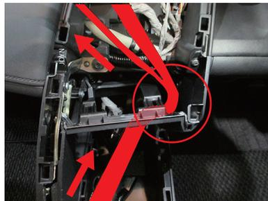
**14** 赤塗り点線枠の隙間に、サウンドアップキットを配線していきます。**12**で外したカプラー部分を隙間から差込んでいきます。
