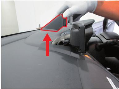
**2** 赤○のネジ(10mm)を2か所を外して、モニターディスプレイのステー部分を取り外します。
