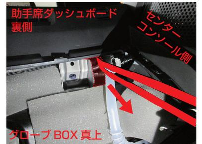
**16** サウンドアップキット側24Pカプラー(オス)をアンプユニットに接続。サウンドアップキット24Pカプラー(メス)を純正電源ハーネス24Pカプラーと接続。
