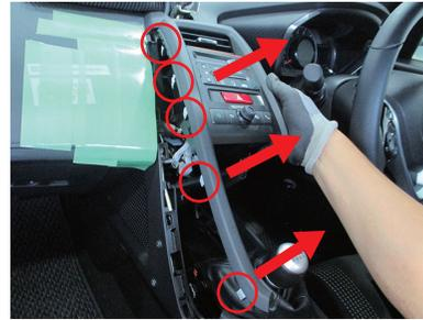
**5** センターコンソールパネル全体を外すと各種操作スイッチ裏あたりにコネクター類が3カ所接続されていますので外します。
