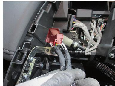
**15** グローブBOX裏側上部にある赤点線枠の隙間からサウンドアップキット(赤塗)を通します。
