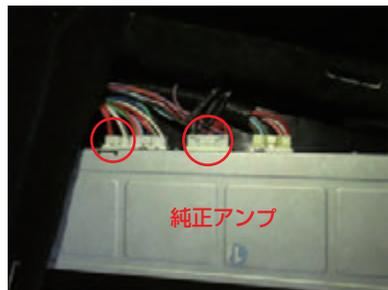
**3** カプラーの取り外しや接続時にスペースが狭く作業性が悪い場合は、純正アンブ固定用の左右のネジ10mmを緩めスペースを確保する。
