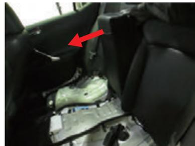
**10** トランクルームからLANケーブル(赤塗り線)を引き込みます。アームレスト下へ配線して、ケーブルが表に出てこないようにします。
