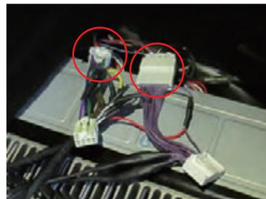
**5** サウンドアップキットのオスカプラー(メス端子)20PINと6PINを、純正アンブに接続します。(赤○箇所)
