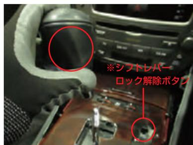
**13** シフトレバーのロックを解除して「D」の位置(赤○)へ移動させ、パネルを外しやすい状態にしてから上方向へ引き上げ、パネルを浮かせます。
