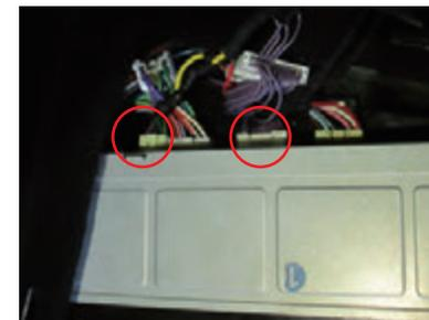
**6** 純正アンブとサウンドアップキットをカプラー接続後、JOYN本体も接続します。AUX接続と専用カプラー接続2か所(赤○箇所)
