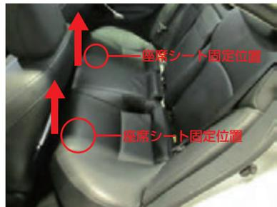
**8** JOYN本体と付属コントローラ接続用のLANケーブルをトランクルームから引込むため、後部座席中央のマットを取り外します。
