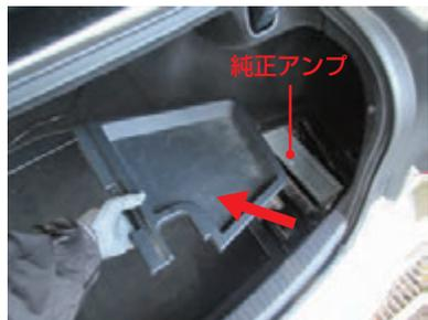
**2** 純正アンブに接続されている赤○2箇所のカプラーを外します。
