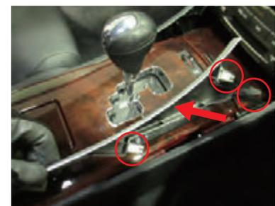
**12** センターコンソールパネル取り外しの為シフトレバーの持ち手部分を切り外します。逆時計回りに回して取り外して下さい。
