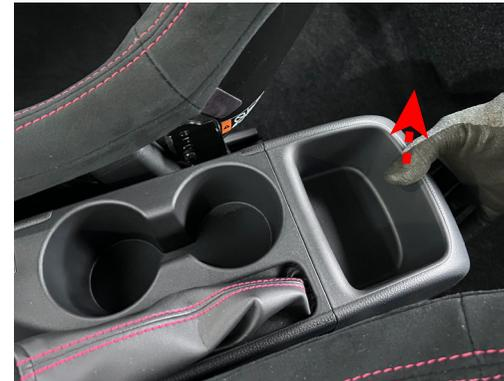
**16** シフトレバーを奥(3速)に入れセンターコンソール前側に指を掛け外します。サイドブレーキのブーツを前方にくぐらせコンソールを外します。
