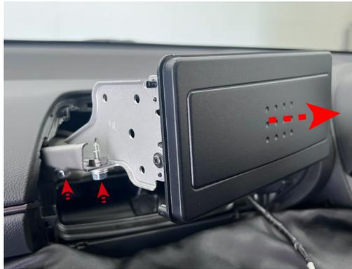
**7** センターコンソールを外して行きます。初めに、エアコンパネル左側の意匠クリップを外します。
