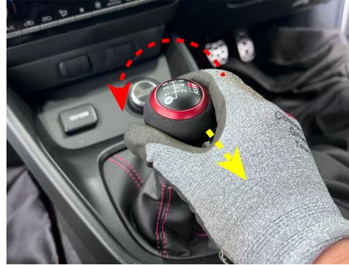
**11** 12の画像の黄破線部に傷防止のため保護テープを貼ります。パネル手前側に指をかけ、シフトパネルを浮かせます。
