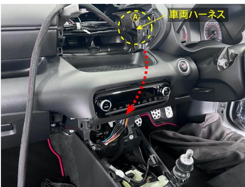
**18** 全てのハーネス/ケーブルをシフトリンケージなど車両の可動部に干渉しないよう、車両ハーネスに沿わせるように配線します。
