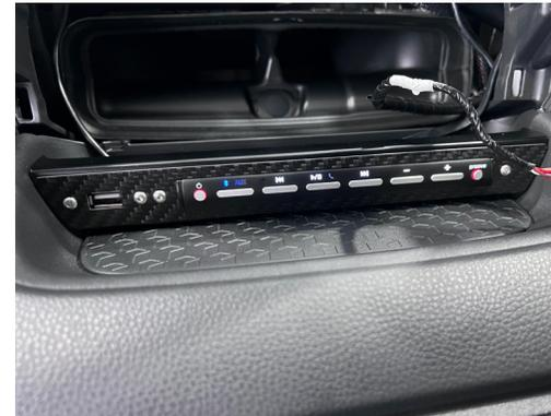
**23** USBケーブルを接続します。異音・抜け防止のため付属のウレタンフォームを接続部に巻いて下さい。(※別紙「取扱説明書4ページ」参照)
