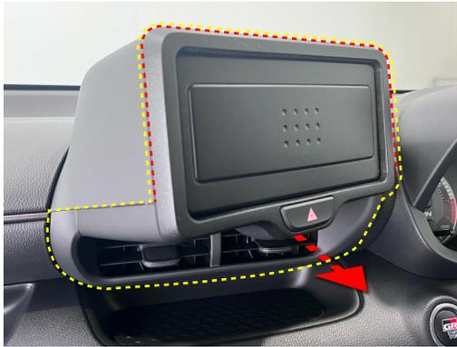
**2** オーディオパネルとベンチレーターパネルが、黄破線部の爪で固く連結されているため、合わせて外すと外しやすいと思います。
