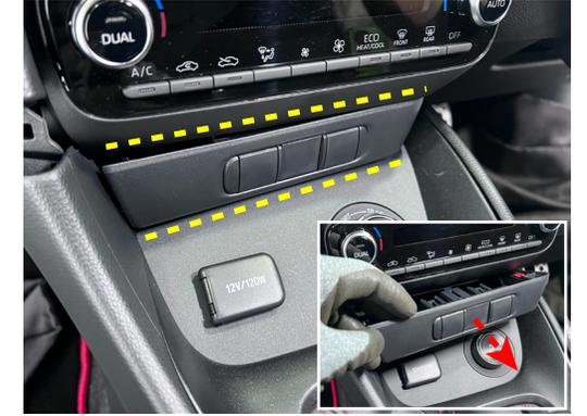
**13** シフトパネルを外します。外す際、シフトブーツ下から内部に手を入れ、シフトブーツの穴を広げギアトリガーをくぐらせます。
