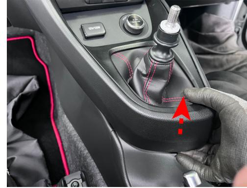
**12** シフトパネルを浮かせるとスイッチパネルが緩みます。指をかけスイッチパネルを外します。
