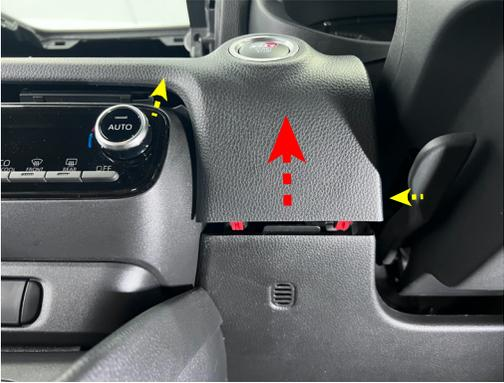
**10** シフトノブを外します。(反時計回りにひねります) 外したらシフトレバーを手前(4速)に入れておきます。(後でシフトパネルを完全に外す際に必要です)
