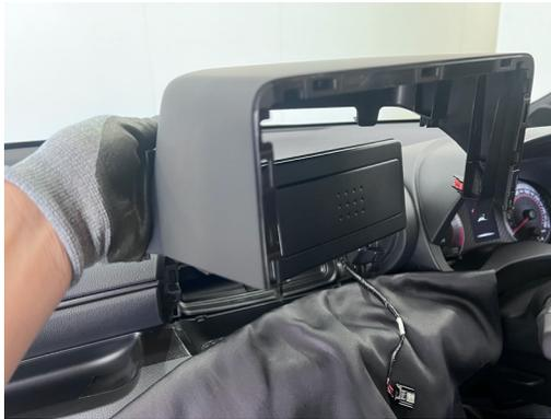
**6** オーディオレスパネル&ブラケットを外します。ブラケット左右ともに下側に10mm六角ボルトで固定されています。(計4本)
