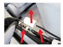
23 エアコンパネル横のサイドパネル を左右とも取り外します。サイド パネルの奥と下の辺りを持って、 手前に引き抜く様に外します。 反動にご注意下さい。(ツメのみ)
