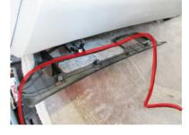
付属コントローラー設置をコンソ ールBOX内とする為、全面部のパ ネルを上方向へ取り外します。
