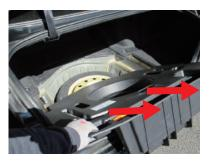
**7**トランクルーム内上部のクリップ 形状(2箇所)は、横面(赤○)に設定 されているボタンを押さえながら 引き抜く様に外します。
