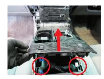
30 純正アンプの上に固定されていた 黒い樹脂カバーを取り外します。
