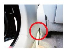
25 センターコンソールの手前側を 上に持ち上げます。赤○2箇所の カプラーを取り外します。 (センターパネルはツメのみ)
