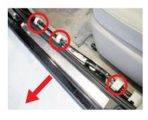
26 センターコンソール全体を外すと 赤○のカプラーが接続されている ので取り外します。同時に赤塗り 位置辺りにLANケーブルを配線。
