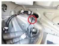
22 12 で外しておいたグローブBOX 下のアンダーパネルの上に、LAN ケーブル(赤塗り)を配線します。
