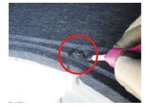
● 赤○右のツメを押しながら片側を 外す事で、赤○左のフックで引っ 掛けて留めている箇所が外せます。 カプラーも取り外します。
