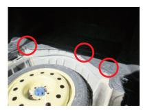
■ トランクルーム内のラゲッジランプを取り外します。正面右側の赤〇箇所に、内張り剥がしなどを差し込んでツメを押しながら片側を外します。
