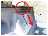
21 19 同様に、赤○3箇所にある結束 \_\_\_ 用の白い樹脂パネルのツメを外し て、その中にLANケーブルを配線 します。
