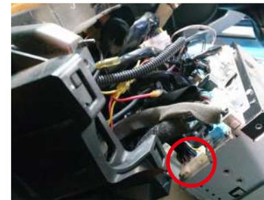
**21** サウンドアップキットの20PINコネクターを、純正オーディオユニットとコネクターの間に割り込ませるように接続します。
