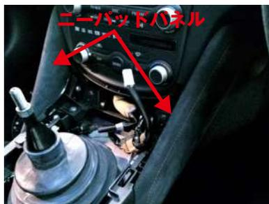
**7** プラスドライバーで4箇所のネジ
