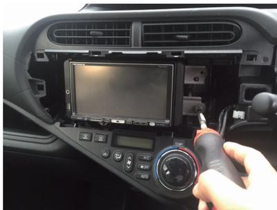
3 車両側とナビオーディオ側24Pカプラーを外し、サウンドアップキットの24Pカプラーを割り込み接続します。(ホンダ車は24Pです。)
