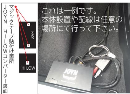
5 付属延長LANケーブルと両面テープを使用してJOYNコントローラーを任意の場所に設置します。
