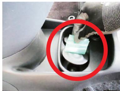
**20** センターコンソール前側も、赤○3箇所の六角フランジナットで固定されているので取り外します。
