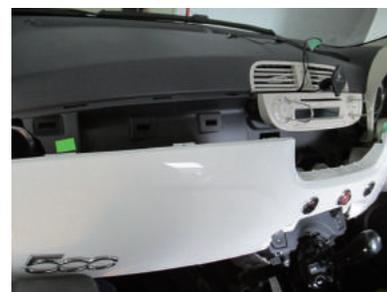
**10** センターパネルを外すと、パネル裏側にカプラー接続が1箇所あるので取り外します。
