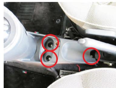
**21** 助手席側、赤○①のトルクスネジ(T25)を外し側面のパネルを取り外し後、赤○②のセンターコンソール前側のトルクスネジ(T25)を外します。
