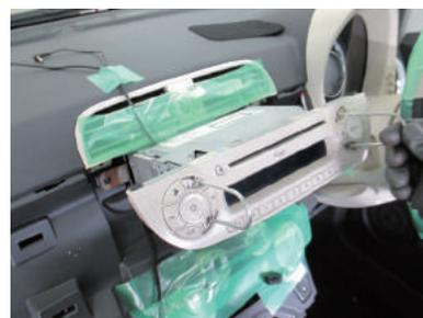
**34** サウンドアップハーネスJOYN SMART STATION本体接続用カプラーから延びている電源取出し用配線(赤色)を、シガーソケットの配線から取出しします。
