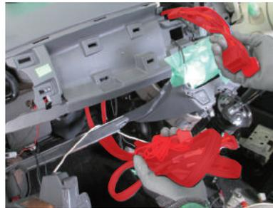
**30** サウンドアップハーネスの純正ハーネス接続用カプラー(赤塗り)と、車両側純正ハーネスのカプラー(赤○)を接続します。
