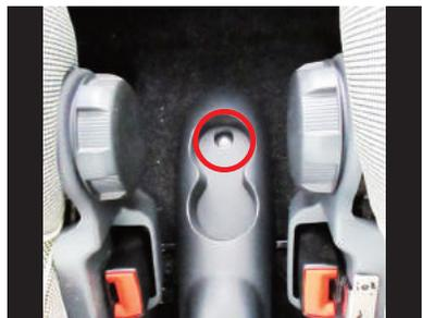
**18** 後部座席側へずらしながら、ドリンクホルダー箇所を上へ引き上げる様にしてセンターコンソール後側を取り外します。
