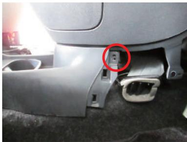
**24** サイドブレーキのレバーを目一杯引き上げておき、センターコンソール前側パネル全体を前方へずらしながら、片側を上へ起こします。
