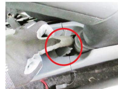
**16** センターコンソール後席用ドリンクホルダーのラバーマットを取り外します。テープなどを貼り、引き上げると取り外ししやすいです。
