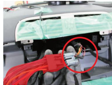
**31** 取り外しておいた純正オーディオ固定用ブラケットを戻してカプラー類とラジオ用アンテナを接続します。ハーネス類は全てブラケットの内側を通してください。
