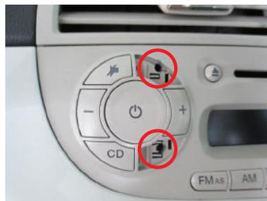
**3** 向かって右側のカバーも同様に外します。赤○の2箇所を**1**の作業手順で**2**の状態にします。
