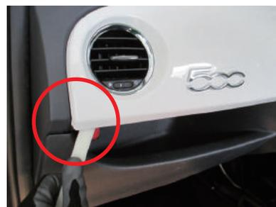
**9** センターパネルの下側を起こしておいてから、上側を手前方向へゆっくり引き抜くようにして取り外します。
