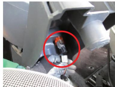
**26** 配線作業の効率を良くする為、サウンドアップハーネスのハイローコンバーターを外しておきます。赤○カプラー接続箇所を外します。
