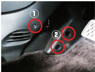
**23** **22**でネジ・ボルト取り外し後に、側面のパネルを取り外します。赤○箇所のトルクスネジ(T25)を外します。
