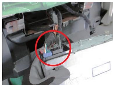
**13** オーディオ固定用ブラケットを取り外す為、赤○①と②のネジと、赤○③の六角ボルト(10mm)を取り外します。
