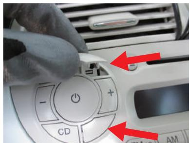
**2** カバーを外すと、赤○の場所に専用の取り出し工具を挿し込む為の丸い穴が設定されています。
