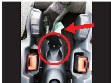
**17** ラバーマットを取り外して、その下にある赤○箇所の六角フランジナット(10mm)を取り外します。
