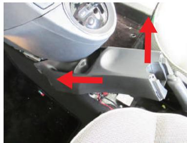
**25** 片側を起こしてパネル裏側のカプラー接続箇所(シガーソケット)を外し、センターコンソール前側を完全に取り外します。
