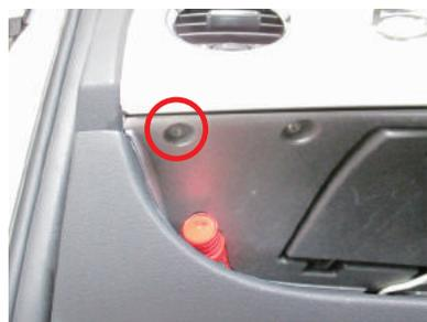
**8** **7**で外したネジのすぐ上辺りの隙間から内張り剥がしを挿し込み、手前に起こすようにパネル全体を少しづつ外します。(ツメのみ)
