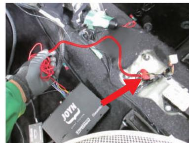
**35** キット付属のエレクトロタップを使用して、純正シガーソケット側灰/赤の線と接続してください。
