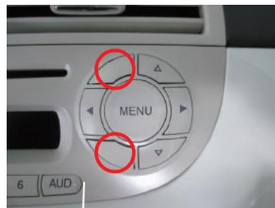
**4** 専用の取り出し工具を左右ともに奥まで挿し込んで、同時に手前方向へオーディオ本体を半分ほど抜き出しておきます。
