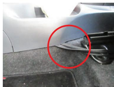
**39** 助手席側のシート下にJOYN SMART STATION本体等を設置・固定します。コントローラー用LANケーブルやカプラー、3.5φオーディオケーブルを接続して、動作確認と出音確認も行います。
