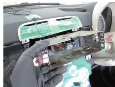
**15** サウンドアップ専用ハーネス配線の為、センターコンソールパネルを取り外します。サイドブレーキ下のカバーを取り外します。
