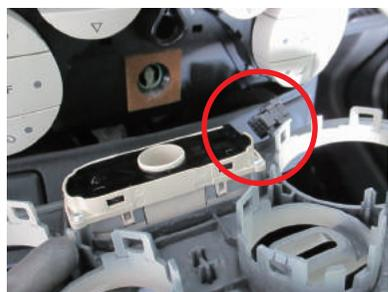
**7** センターパネルを取り外す為、グローブBOX天面に設定されている赤○のネジを1箇所外します。
