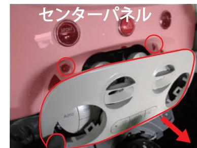
**6** 外したエアコンパネルの裏側にカプラー接続が1箇所あるので取り外します。
